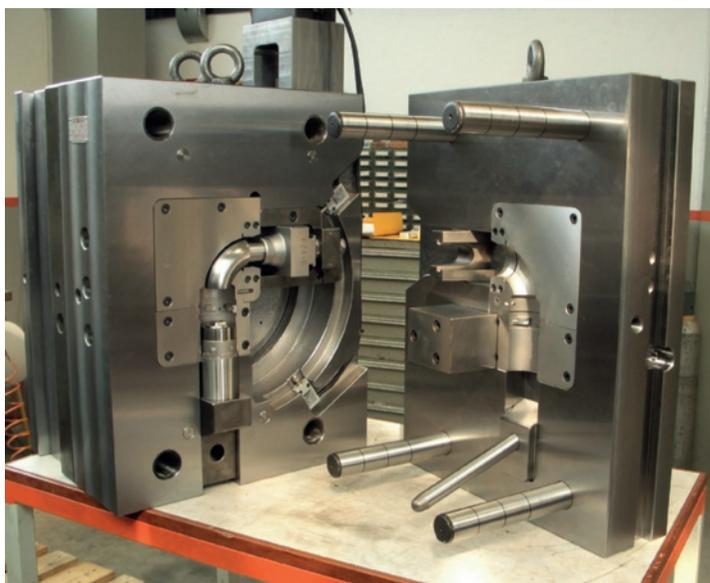
Stampo con movimento circolare dell'inserto carrello ottenuto mediante cilindro idraulico.
