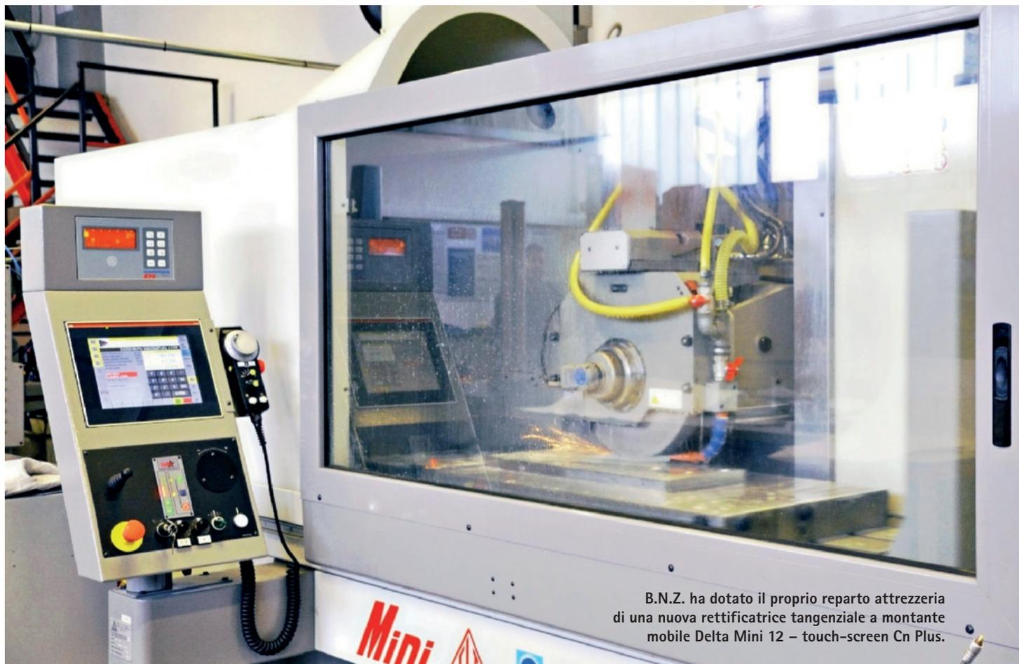
B.N.Z. ha dotato il proprio reparto attrezzatura di una nuova rettificatrice tangenziale a montante mobile Delta Mini 12 – touch-screen Cn Plus.
