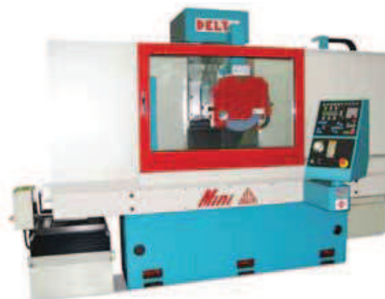
La Mini 7 cn ha permesso di ottenere rugosità minime di Ra 0,05
