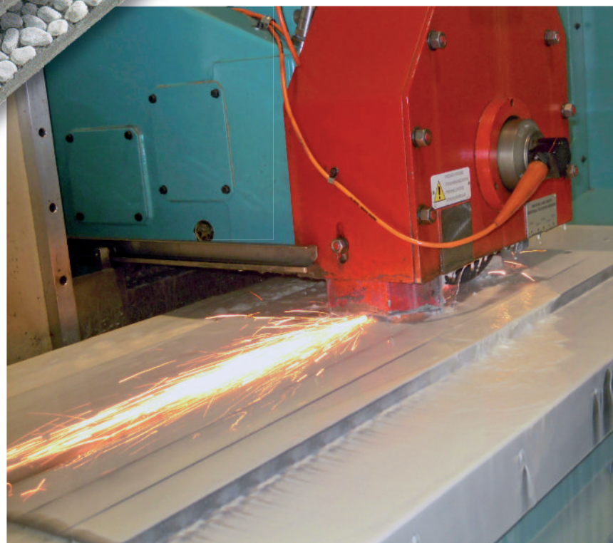
Rettificazione delle lastre che poi costituiranno lo stampo, eseguita su Delta Maxi 1500/750.
