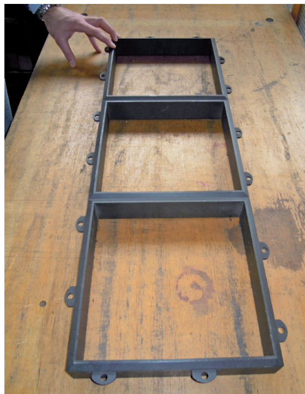
Particolare stampo costituito da tre forme quadrate.
