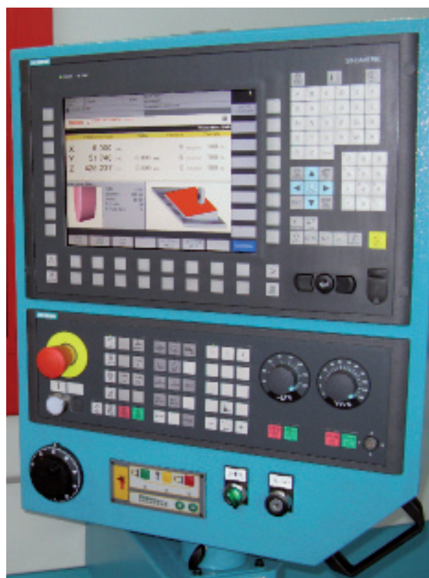
CNC Delta basato sull'unità di controllo Siemens Sinumerik 840DI.
