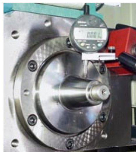
Il test sulla qualità di movimento del mandrino a sostentamento idrodinamico
