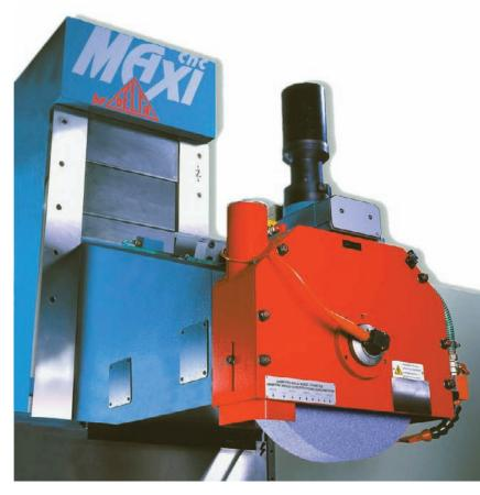
stabilizzata e caratterizzate da un elevato coefficiente di smorzamento per conferire al sistema massima rigidezza e stabilità dinamica. Sull'intera corsa di lavoro, le guide della testa portamola poggiano su quelle del montante; quest'ultimo, a sua volta, rimane a completo contatto con il basamento trasversale per tutta la corsa. Lo stesso discorso vale per le guide della tavola portapezzi che, anche alla massima corsa, sono sempre in presa completa con quelle del bancale aventi lunghezza più
