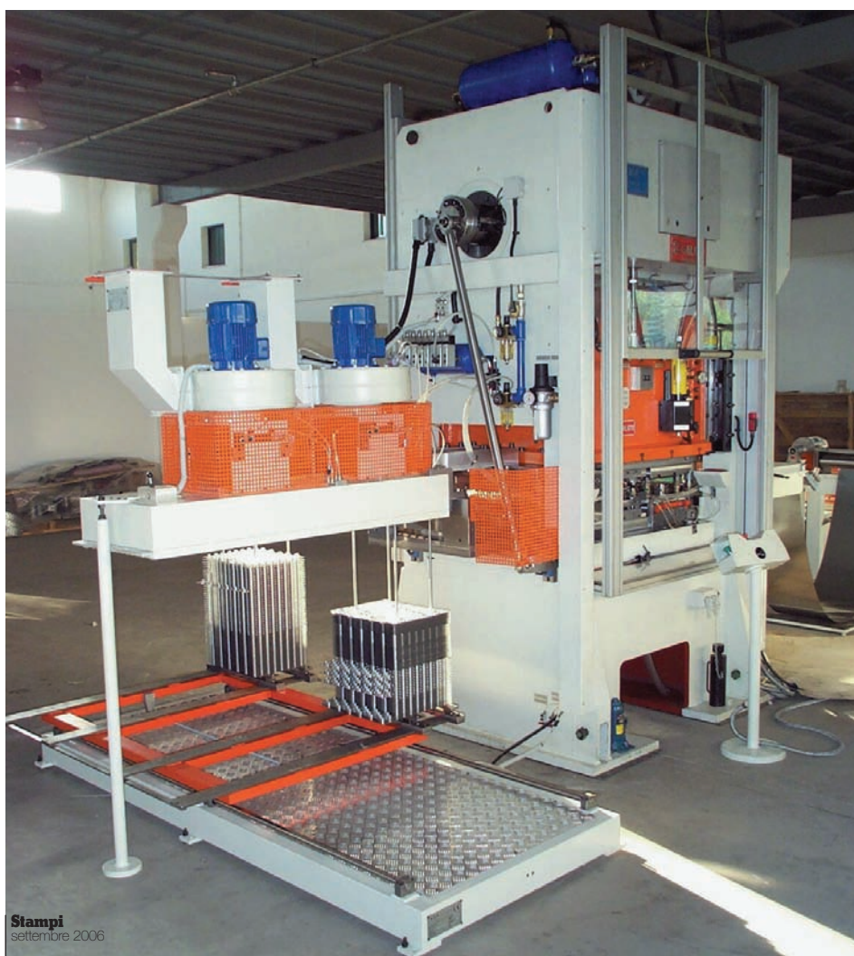
Fig. 4 - Linea completa di produzione per lamelle di scambiatori: A.M.P. possiede completamente questa tecnologia e offre dette linee "chiavi in mano"
